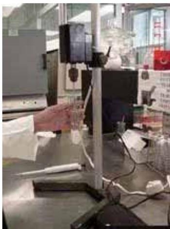
**Figura 6.1** Homogeneizador de tejido construido con un motor de máquina de coser (Fotografía cortesía de Gabriela Rodríguez-Fuentes)
