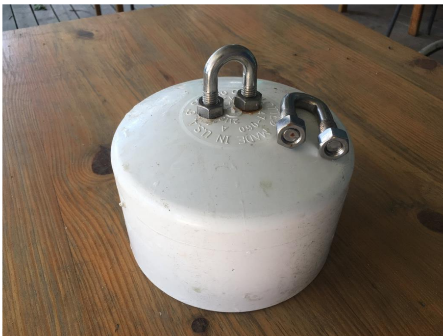
FOTOGRAFÍA 27. PARTE INFERIOR DE UNA BOYA DE MARCACIÓN DE CANALES
