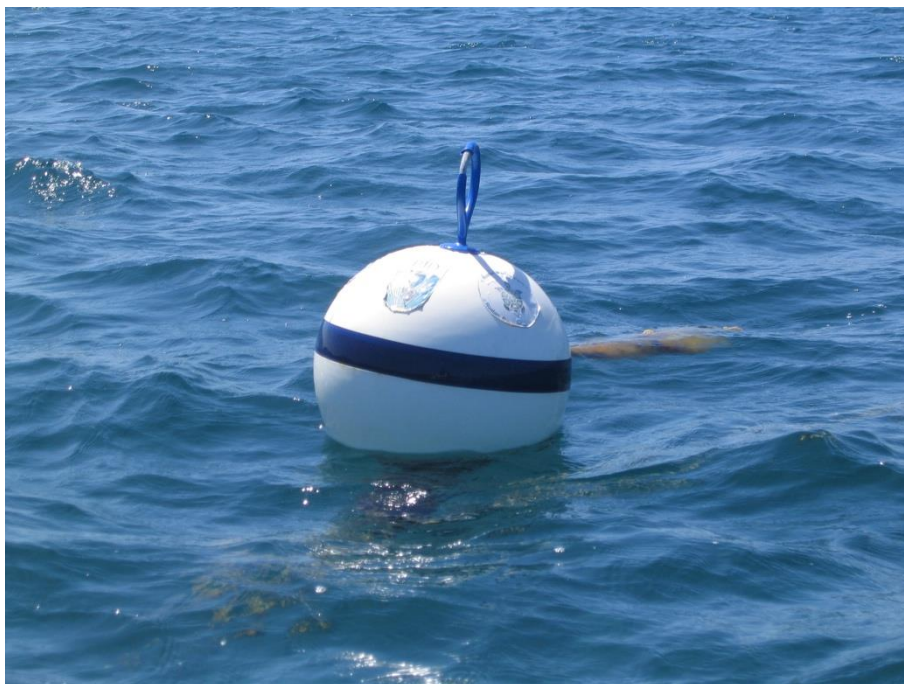
FOTOGRAFÍA 31. BOYA PARA VELERO YA INSTALADA
