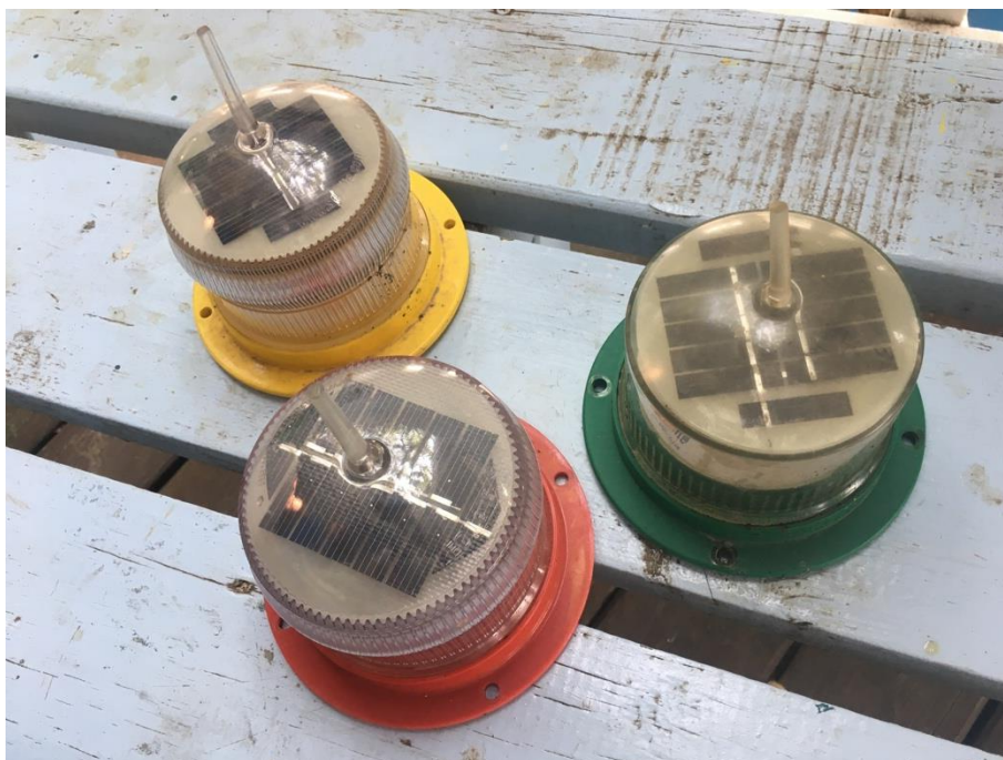
FOTOGRAFÍA 26. EJEMPLOS DE LAS LUCES INDICADORAS QUE SE INSTALAN EN LA PARTE SUPERIOR DE LA BOYA DE MARCACIÓN DE CANALES
