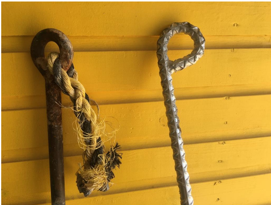
FOTOGRAFÍA 18. DETALLE DE LAS CABEZAS DE LOS TORNILLOS DE ARENA
